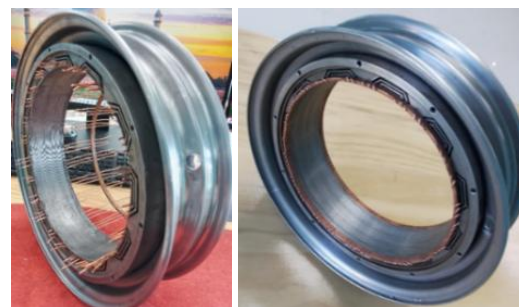
Рисунок 9 – Етапи виготовлення ротора СРД з додатковою обмоткою
