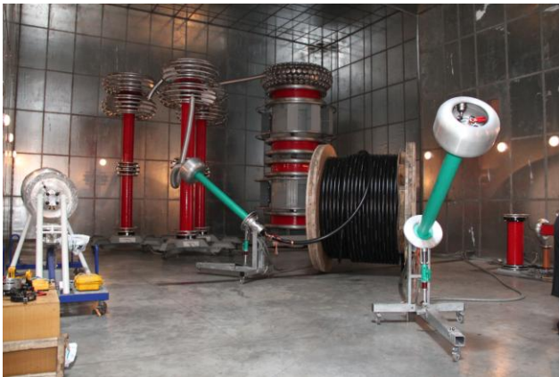
Рисунок 4 – Модульна резонансна система на напругу до 330 кВ для випробування високовольтних ЗПЕ-кабелів
