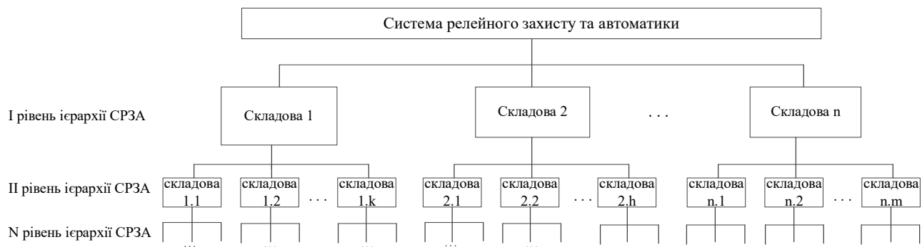
Рисунок 1 – Ієрархічна структура мікропроцесорної СРЗА
