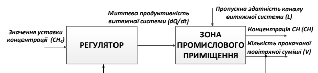
Рисунок 2 – Графічне представлення зони промислового приміщення та його входних і вихідних параметрів
