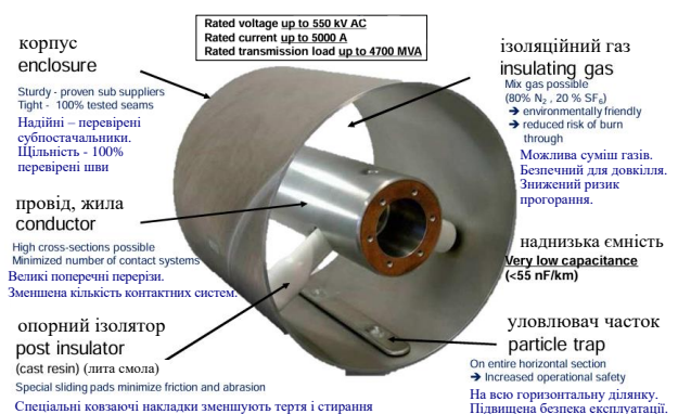
Рисунок 11 – Конструкція системи GIL
