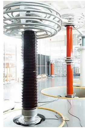
Рисунок 4 – Високовольтні вводи виробництва ABB [6, 7]
