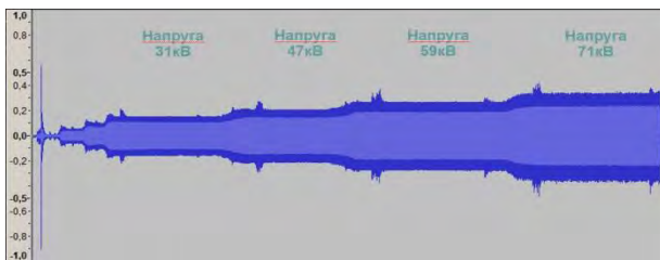
Рисунок 3 – Амплітудне представлення файлу експерименту з поступовим підвищенням напруги
