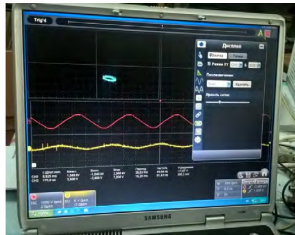
Рис. 5 – Типова залежність між поляризацією і напруженістю електричного поля для конденсатора з активним діелектриком
