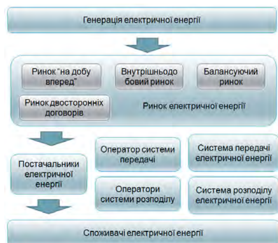
Рисунок 1 – Структурна схема системи передачі та розподілу електричної енергії, що запроваджується в Україні
