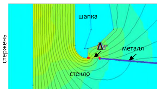
Рисунок 2 – Обострение напряженности электрического поля у торца электрода – шапки изолятора металлизированной поверхностью
