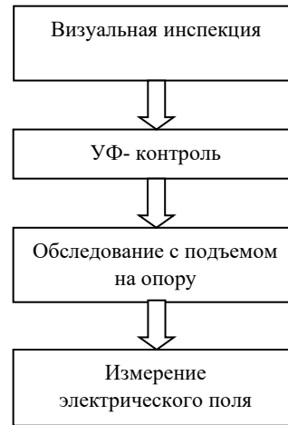
Рисунок 1 – Схема контроля полимерных изоляторов, используемая в Италии
