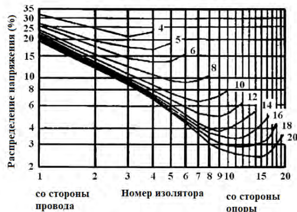
Рисунок 4 – Распределение напряжения от количества изоляторов составляющих гирлянду
