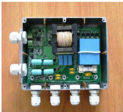
Рис. 10 - Розроблений і виготовлений DC-DC перетворювач
