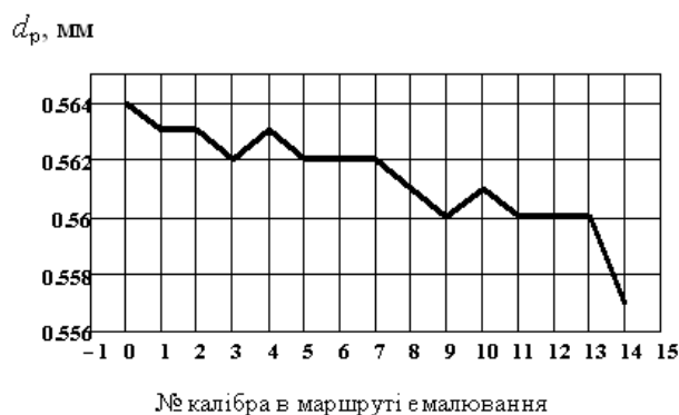
Рис. 2 – Діаметр мідного провідника d_p після проходження відповідного калібру в маршруті емалювання: впродовж маршруту відбувається технологічна витяжка провідника, яка складає більше одного відсотка
