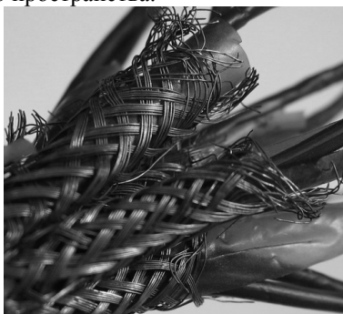
Рис. 1 - Экраны пар контрольного кабеля КПЭТИ 7×2×0,7.
