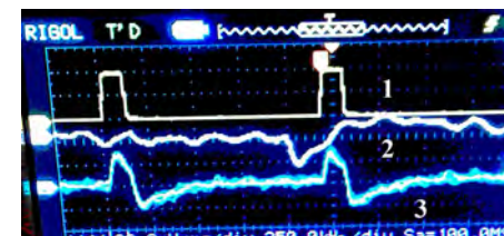
Рис. 5 – Результаты измерения ЧР при максимально уменьшенных внешних и внутренних помехах. 1 – вводимый прямоугольный импульс; 2 – полученный сигнал ЧР; 3 – результирующий сигнал
