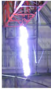
Рис. 7 – Перекрытие гирлянды стеклянных изоляторов при параллельном подключении гирлянды и макета удлиненного полимерного изолятора к источнику импульсного напряжения.
