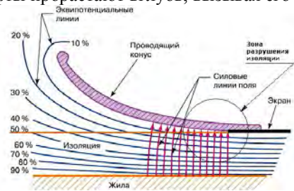
Рис. 6 – Модель электродов концевой муфты кабеля
