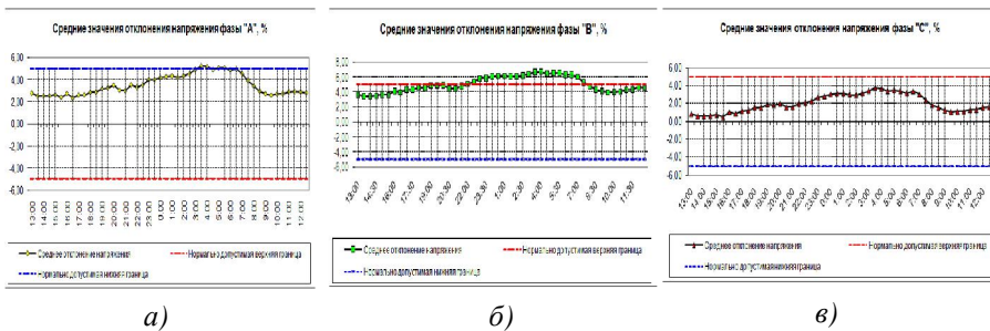
Рис. 5 – Среднее значение установившегося отклонения напряжения: а – для фазы «А»; б– для фазы «В»; в– для фазы «С»
