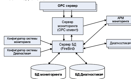
Рис. 1 – Основные компоненты программного и информационного обеспечения и потоки данных системы «Д+»
