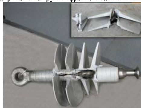
Рис.2 – Изолятор типа ПСК 120-3,3-7, пробитый импульсным напряжением с крутым фронтом волны
