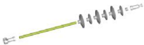
Рис. 1 - «Шашлычная» конструкция полимерного изолятора
