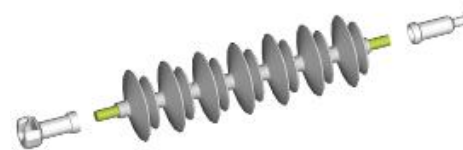
Рис. 3 - Цельнолитая конструкция полимерного изолятора
