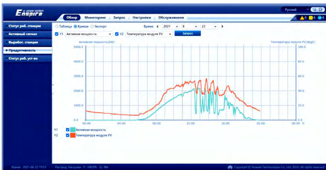
Рисунок 1 – Графіки залежності активної потужності та температури ФЕМ
