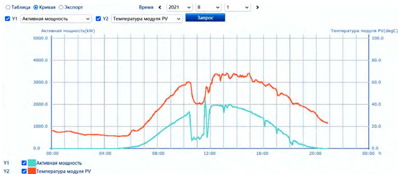
Рисунок 6 – Графіки залежності активної потужності та температури ФЕМ 1.08.2021 р.
