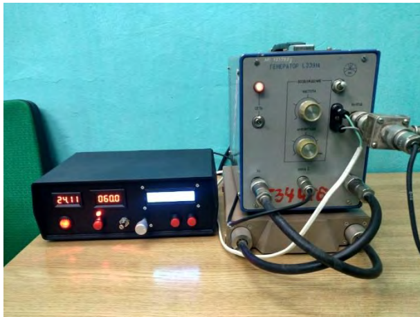
Рисунок 7 – Зовнішній вигляд високовольтного імпульсного генератора розроблений [9, 10]
