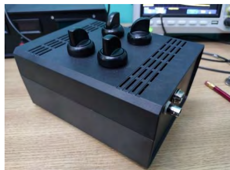
Рисунок 4 – Зовнішній вигляд генератора імпульсів високої енергії
