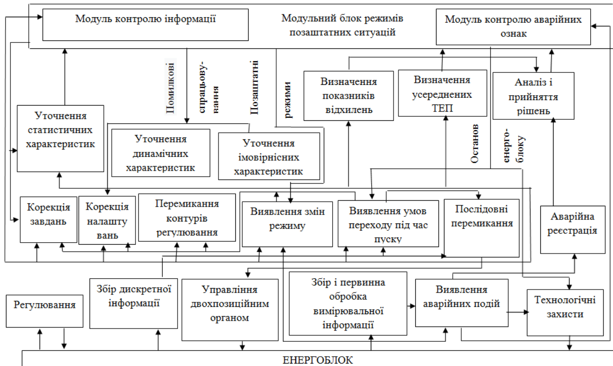
Рисунок 4 – Інформаційно-алгоритмічна схема АСУТП енергоблоку при функціонуванні електроенергетичного обладнання в позаштатних режимах
