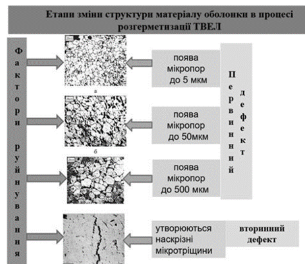
Рисунок 1 – Процес утворення первинних і вторинних дефектів при пошкодженості структури матеріалу оболонки ТВЕЛ
