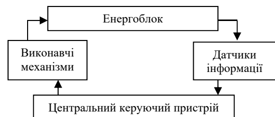
Рисунок 1 – Варіант структурної схеми АСУТП енергоблоку з повністю централізованою системою обробки інформації в штатному режимі функціонування
