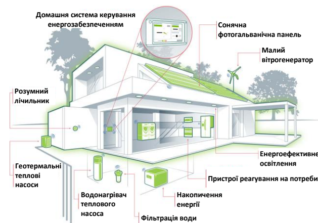
Рисунок 1 – Схемна конфігурація гібридного енергокомплексу «Активного» будинку
