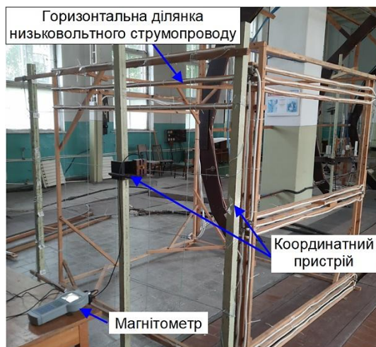
Рисунок 8 – Лабораторний макет струмопроводу низької напруги ТП 10/0,4 кВ, 100 кВА на магнітовимірювальному стенді інституту
